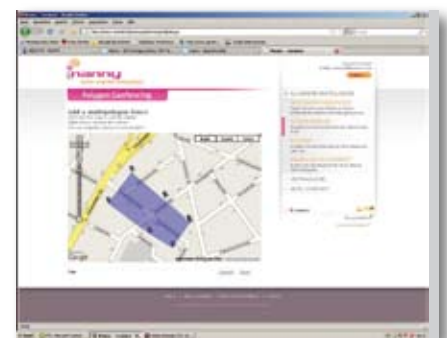
Sperrgebiet: Wenn die Geofences (gefärbte Fläche) betreten oder verlassen werden, macht die iNanny Meldung per SMS.
